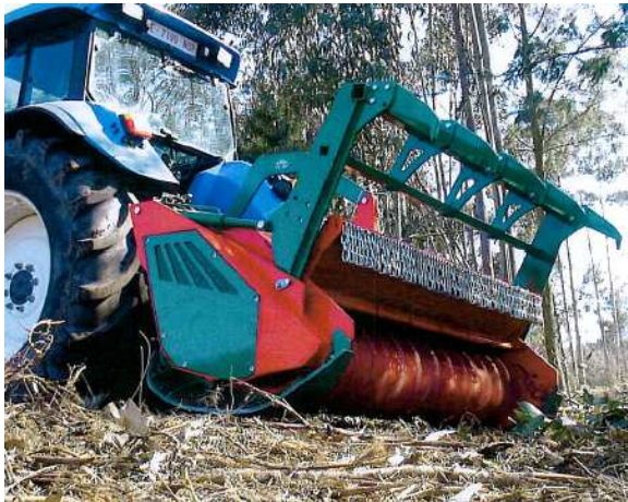
Trituradora forestal de martillos fijos implementada en tractor forestal llevando a cabo trabajos de desbroce.
